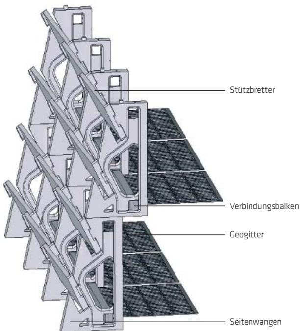
Die großformatigen und relativ leichten Frontelemente ermöglichen ein schnelles Arbeiten mit geringem Montageaufwand. Die bei der Herstellung direkt im Frontelement stoffschlüssig verankerten einaxialen Tensar® Geogitter-Anschlussstücke werden – je nach statischer Anforderung – kraftschlüssig verlängert. Diese kraftschlüssige Verbindung ist schnell und einfach mittels spezieller Kunststoffsteckstäbe durchführbar.
