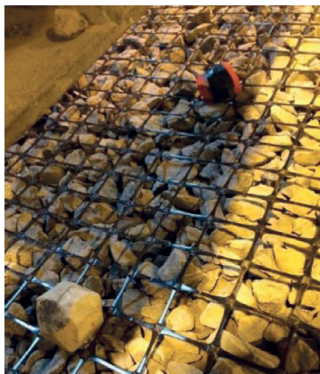
Bild 7: Herstellung des Versuchsaufbaus mit Smart-Rock-Messinstrumenten – links mit BX-Geogitter, in der Mitte mit TX-Geogitter und rechts Untergrund [3]
